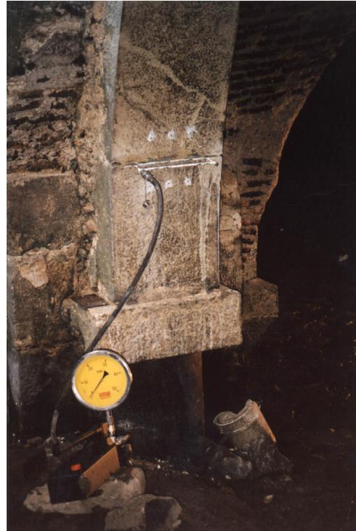
**Fig. 12 – Iglesia de Santa Clara-a-Velha - Ensayo de cilindro plano de simple efecto para la evaluación de las tensiones en los arcos.**
