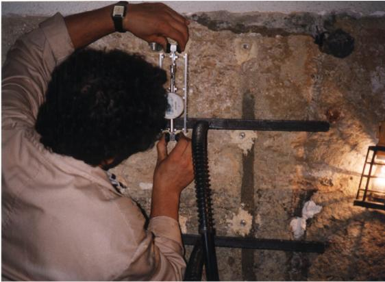
**Fig. 11 – Edificio de mampostería en Lisboa - Ensayo de cilindro plano doble para la evaluación de las propiedades mecánicas**
