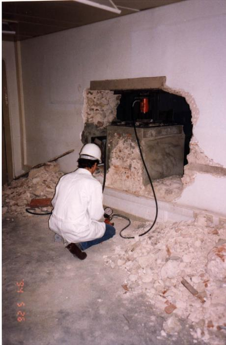
**Fig. 15 – Edificio de mampostería en Lisboa - Ensayo de corte destructivo**
