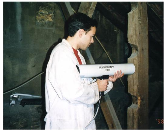
**Fig. 14 – Ensayo resistográfico sobre elementos de madera**
